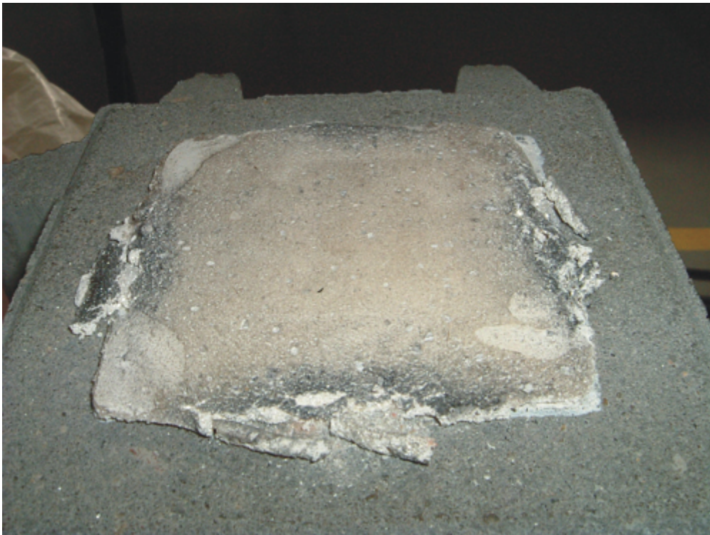
Abbildung 7: Kaltplastik nach Langzeitversuch bei Belastung mit elf kN
