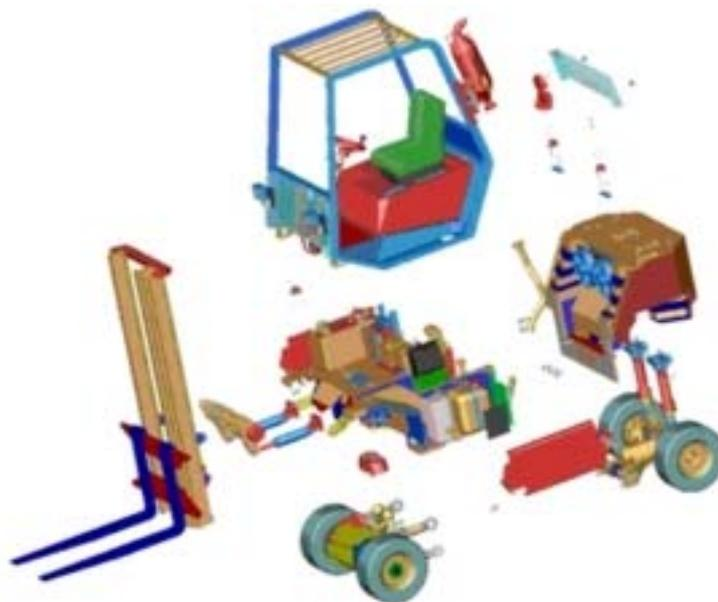
Abbildung 1: Explosionsansicht des Funktionsmusters
