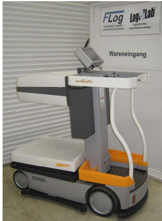
Abbildung 1: Detailansicht des RFID-gestützten Kommissioniergeräts
