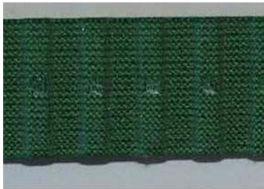
Abbildung 14: zerstörtes Gewebe in Folge thermischer Überlastung
