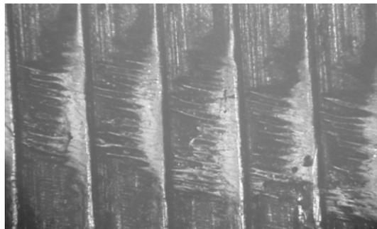
Abbildung 9: beginnende polymere Ablagerung auf Stahlprobe Rz28
