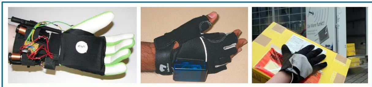
Abbildung 2: Gestaltung eines tragbaren RFID-Lesegerätes ([Lus-07], [Phi-04], [IFF-10])
