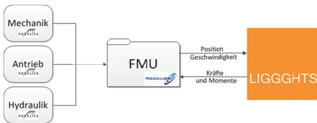
Abbildung 6. Gekoppelte DEM-MKS-Simulation durch die entwickelte FMU-Schnittstelle in LIGGGHTS.
