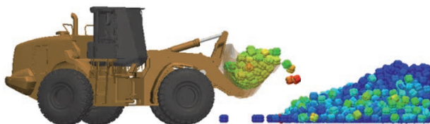
Abbildung 7. Anwendungsbeispiel „Radlader“ für die gekoppelte DEM-MKS-Simulation mit FMU und LIGGGHTS.
