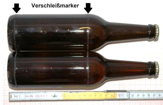
Abbildung 13: Typische Verschleißmarker an der Berührungslinie zweier Flaschen
