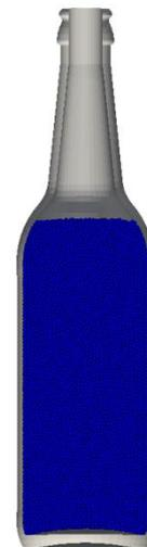
Abbildung 7: einzelne, mit DEM-Partikeln gefüllte Flasche
